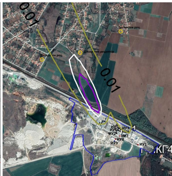
Фигура IV.1.3-12 Максимална еднократна концентрация на \text{NO}_x , \mu\text{g}/\text{m}^3 в района, при скорост на вятъра 2.5 \text{ m/s} и клас на устойчивост на атмосферата С- след реализацията на ИП
