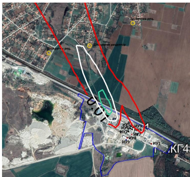
Фигура IV.1.3-10 Максимална еднократна концентрация на \text{NO}_x , \mu\text{g}/\text{m}^3 в района на „Каолин“ ЕАД, при скорост на вятъра 4.0 m/s и клас на устойчивост на атмосферата С- след реализацията на ИП
