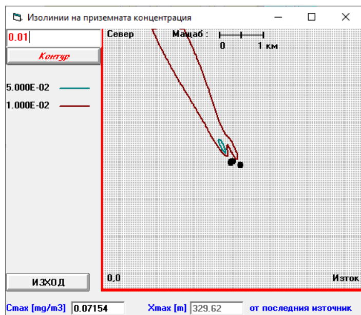
Фигура IV.1.3-10 Максимална еднократна концентрация на \text{NO}_x , \mu\text{g}/\text{m}^3 в района на „Каолин“ ЕАД, при скорост на вятъра 4.0 m/s и клас на устойчивост на атмосферата С- след реализацията на ИП
