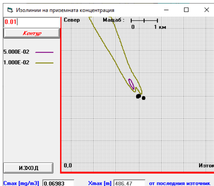
Фигура IV.1.3-12 Максимална еднократна концентрация на \text{NO}_x , \mu\text{g}/\text{m}^3 в района, при скорост на вятъра 2.5 \text{ m/s} и клас на устойчивост на атмосферата С- след реализацията на ИП
